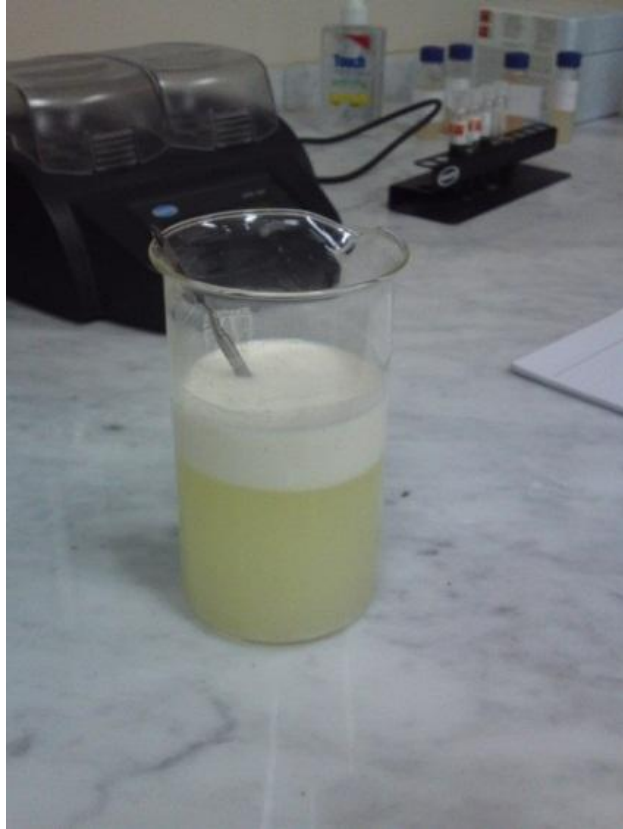
الشكل 21 تحديد جرعات المواد المنخثرة والمندفة اللازمة للمعالجة الكيميائية
