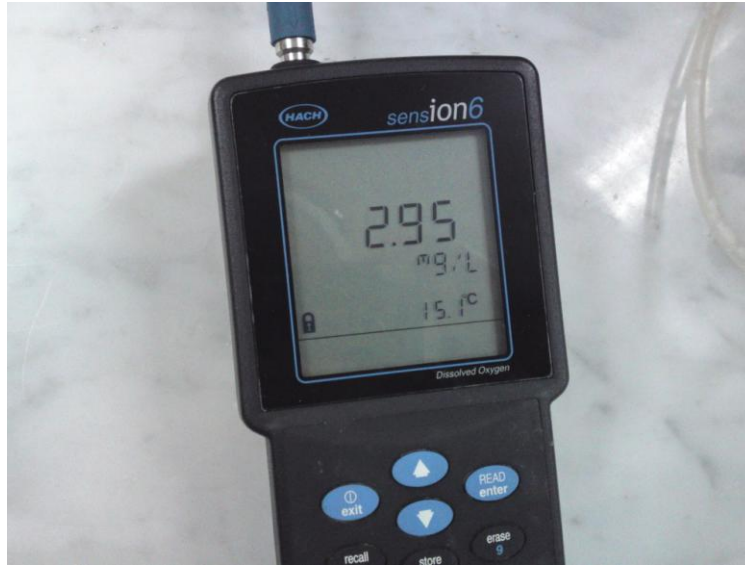
الشكل 15 قياس الأكسجين المنحل DO
