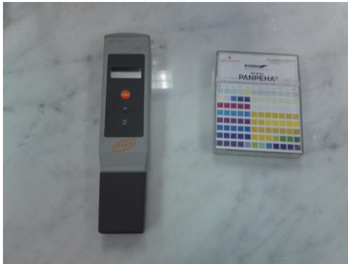
الشكل 14 قياس درجة الحموضة pH
