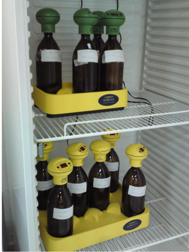
الشكل 12 قياس الأكسجين البيولوجي المحتاج BOD5
