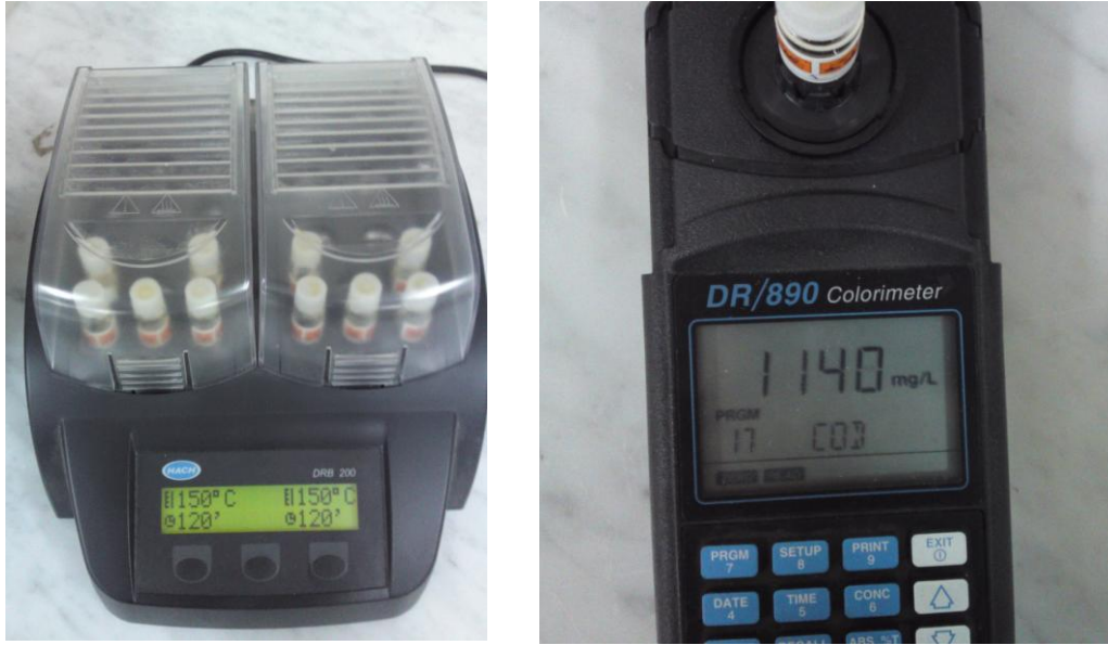
الشكل 13 قياس الأكسجين الكيميائي المحتاج COD
